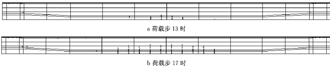
图 7 典型加载步下预应力混凝土 T 梁的裂缝发展图
