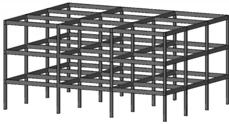
图5 钢框架结构有限元模型 Fig.5 FE model of steel frame structure
